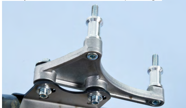
Montaje recomendado en cárter de paso largo
